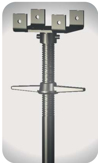
GHI – D 15 Kopfspindel 38 / 52 Die Kopfspindel leitet die Aufnahmelast in die Rahmenstützen und gleicht Neigungen bis zu 6 % aus. Verstellbereich von 6 cm bis 29,5 cm
