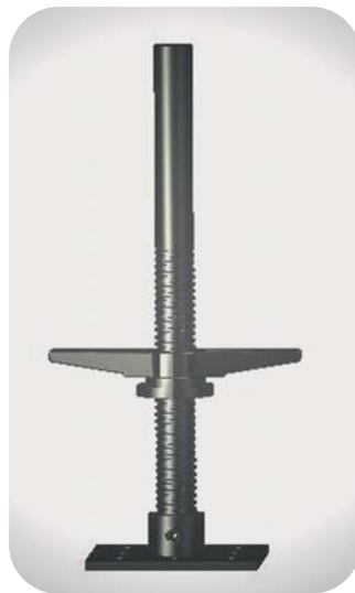
GHI – D 15 Fußspindel 38 / 52 Die Fußspindel gleicht eben- falls Neigungen bis zu 6 % aus und verfügt über einen Verstellbereich von 6,5 cm bis 30,0 cm
